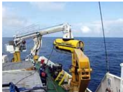
Un sonar mis à l'eau à l'aide d'une grue
